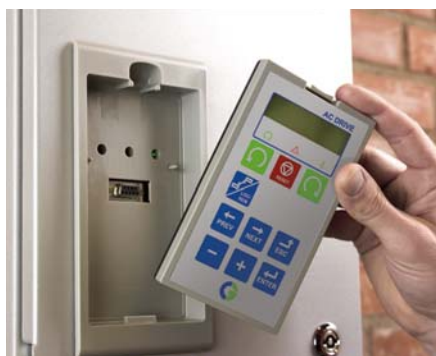
Fig. 1 När du tar bort täckpanelen eller kontrollpanelen kommer du att kunna ansluta den handhållna kontrollpanelen.
